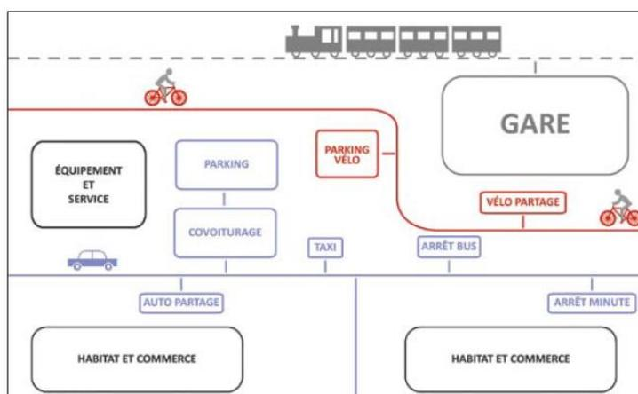
**Schéma indicatif de composition optimal d'un pôle multimodal.**
