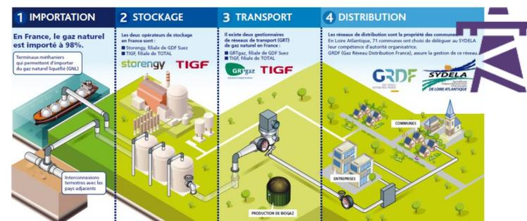
Figure 25 - Schéma explicatif sur le transport et la distribution de gaz (sydela.fr)
